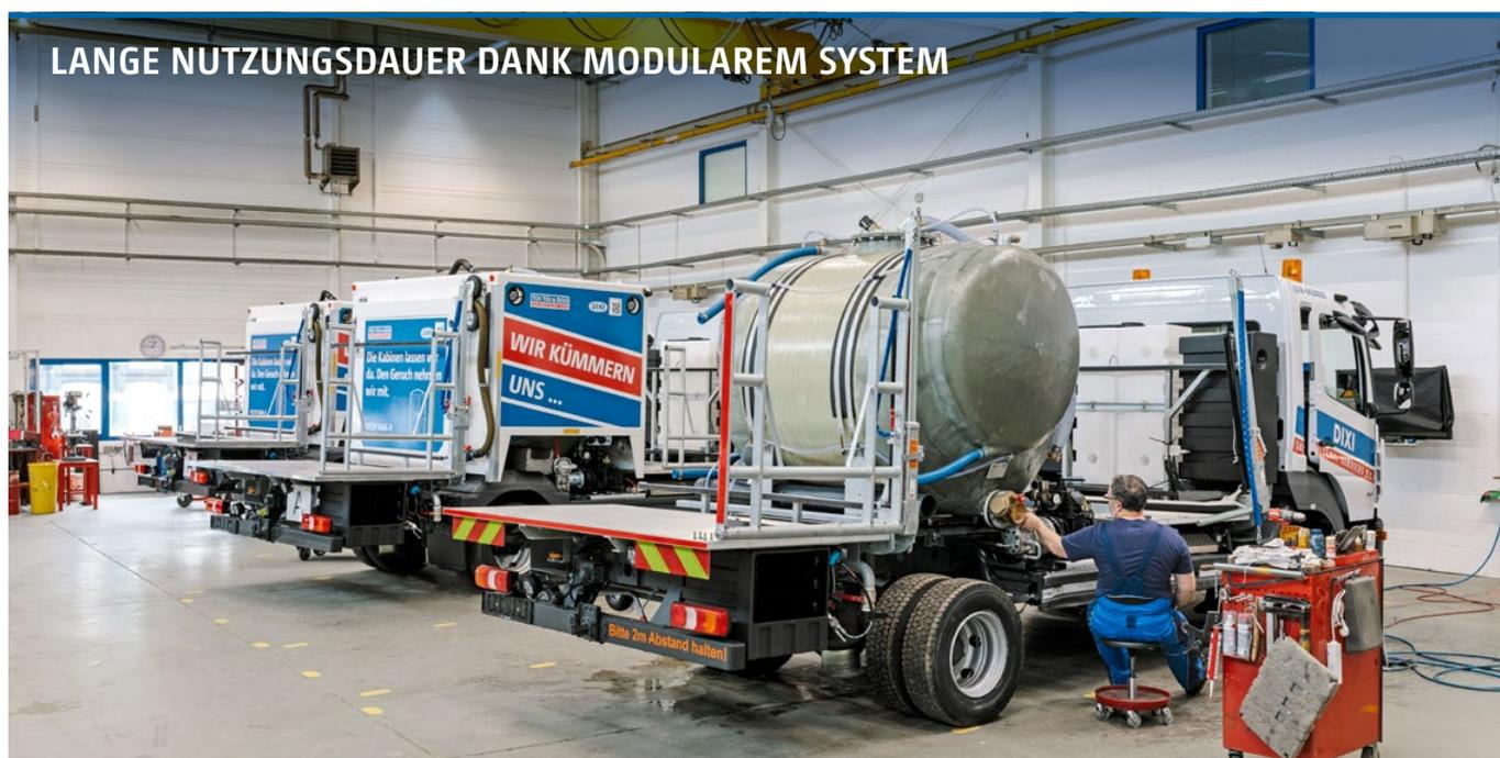
Bei unseren Servicefahrzeugen lassen sich die verschiedenen Aufbauten problemlos wechseln. Das erhöht die Langlebigkeit der Einzelteile und leistet so einen Beitrag zur Nachhaltigkeit.
